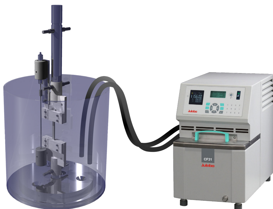
FIGURE 6.4 – Représentation du montage réalisé pour les essais de vieillissement thermo-hydro-mécanique
