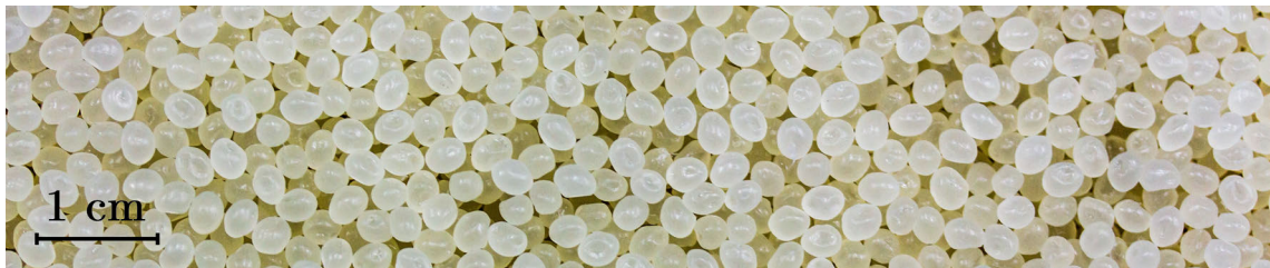
FIGURE 5.1 – Granulés de PLA NatureWorks® Ingeo™ 7000D
