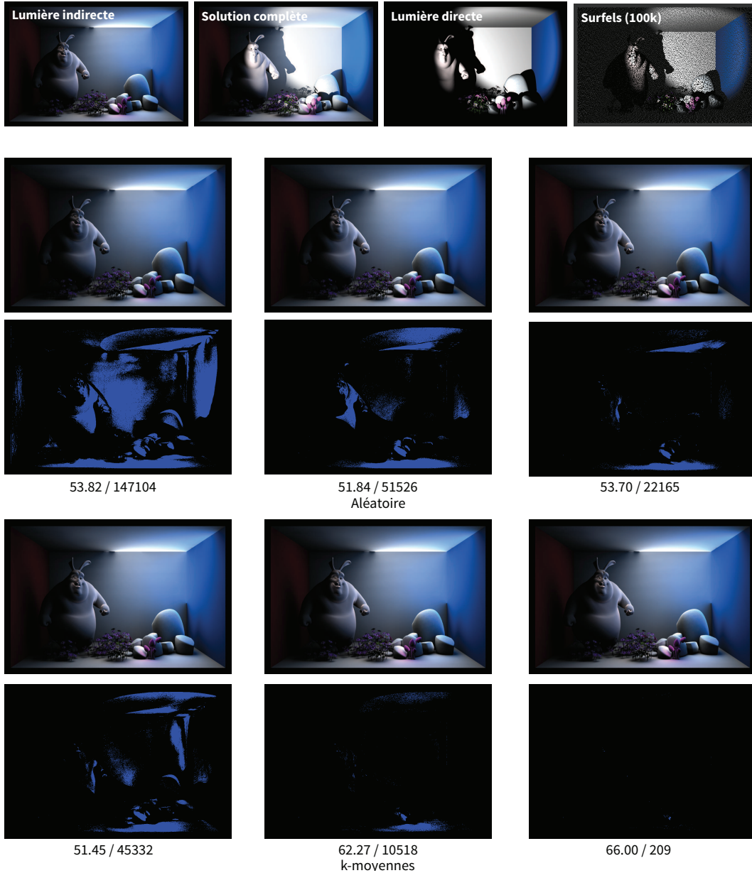
Figure 11 : Résultats et Comparaison. Quelques résultats et la comparaison avec un choix aléatoire de représentants. Nous montrons le nombre de pixels perceptuellement différents (PPD) [Yee04] et le peak signal-to-noise ratio (PSNR) par rapport à la référence (image dénotée "Lumière indirecte") en format <PSNR/PPD> sous chaque résultat. On observe une baisse rapide de PPD et une hausse de PSNR qui sont supérieures à celles du choix aléatoire. En général, les résultats convergent rapidement à un niveau d'erreur peu perceptible.
