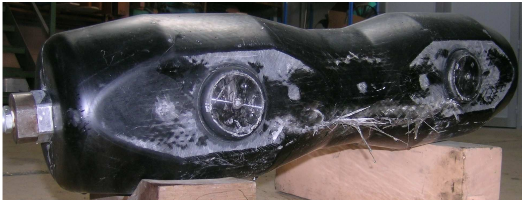
FIGURE 7.17 – Eclatement du réservoir à 280 bars sous pression hydraulique
