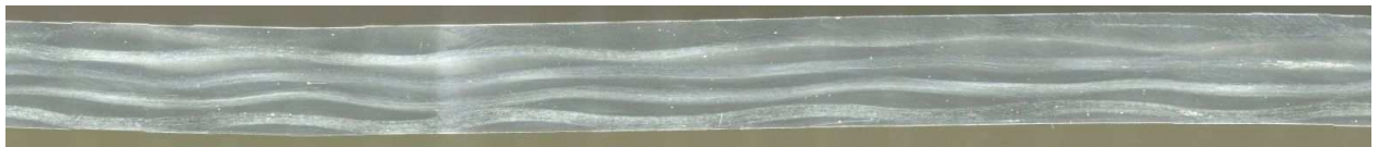
FIGURE 2.18 – Mise en évidence des ondulations des torons axiaux
