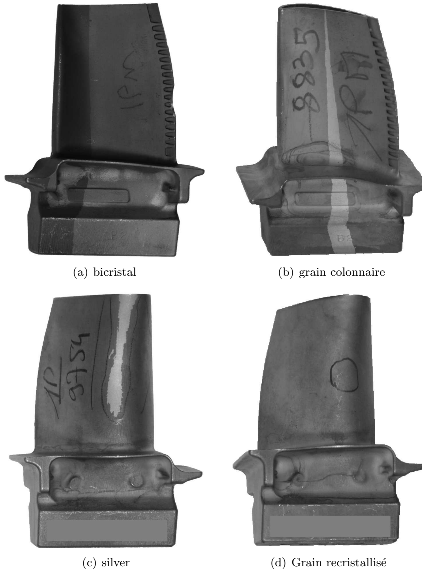
FIGURE 2.4 – Défauts de fonderie de type grain parasite
