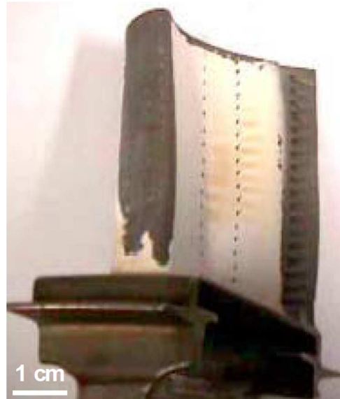
Figure 1.9 – Érosion de la zircone sur le bord d'attaque d'une pale haute pression [THE07]
