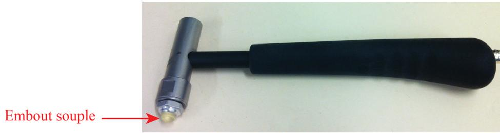
FIGURE 9.3. Marteau utilisé pour engendrer la force extérieure.
