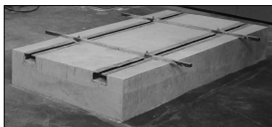
Figure 20 : dalle principale après séchage
