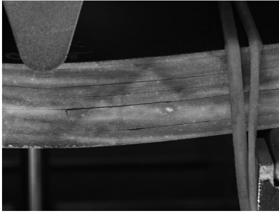
Figure V-34: Faciès de rupture observés sur un empilement UD (16 plis) pour l'essai de cisaillement interlaminaire.
