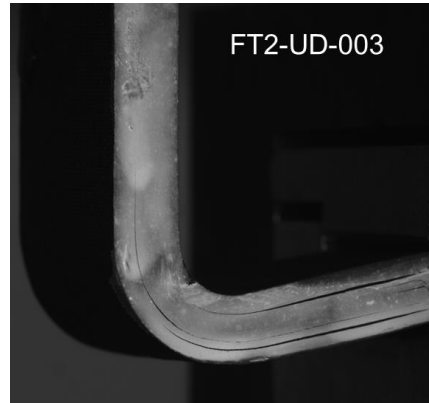
Figure V-10: Faciès de rupture pour un stratifié UD pour l'essai de pliage.
