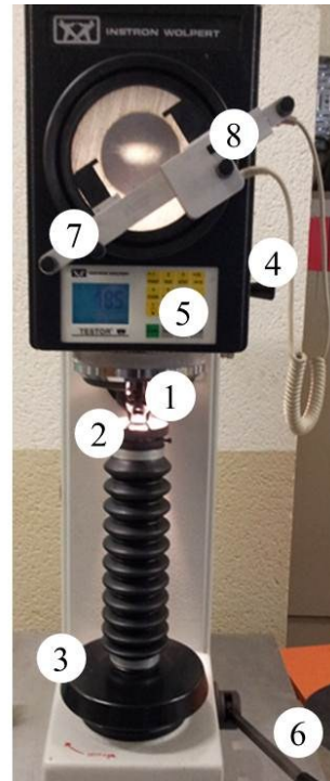
Figure 141. Machine d'essais de dureté (Testwell-Testor HT 1a du LaBoMaP)
