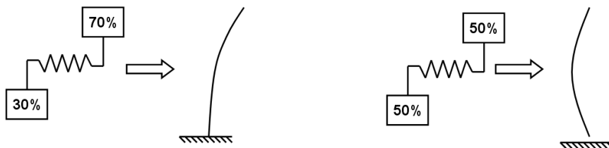
FIGURE 4.7 – Répartition de masses équivalentes en fonction des conditions de contact
