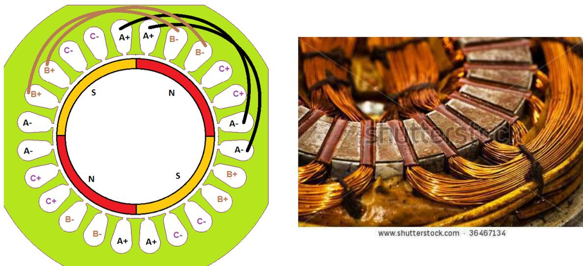
Figure 1-7 Exemple d'un bobinage croisé réparti
