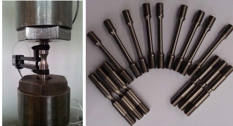
FIGURE III.29 – Montage de traction et les éprouvettes utilisées
