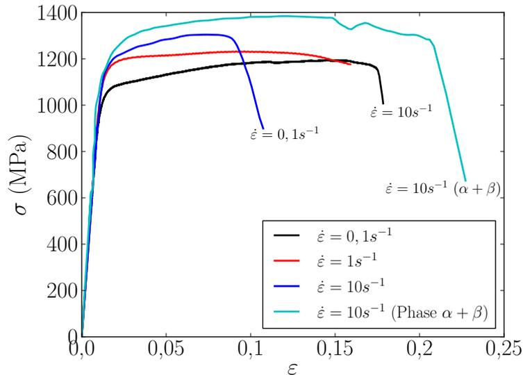
FIGURE III.70 – Comportement de la phase  $\beta$  à différentes vitesses de déformation
