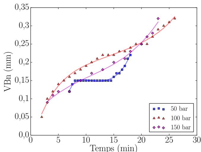
FIGURE II.34 – Évolution de l'usure en entaille,  $V_c=75$  m/min
