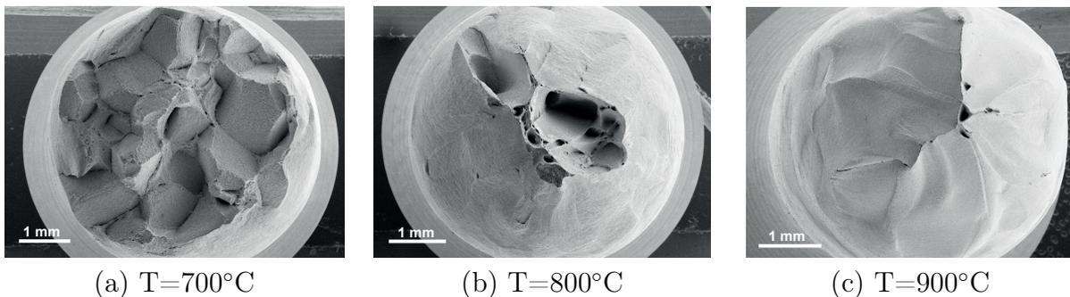
FIGURE III.36 – Faciès de rupture à différentes températures
