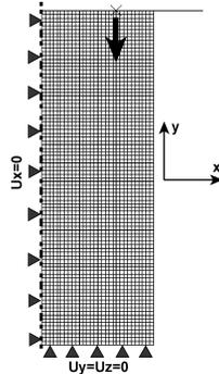
FIGURE III.16 – Modèle EF de l'éprouvette de compression
