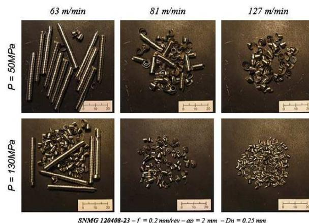
FIGURE I.29 – Influence de la pression sur la fragmentation du copeau (inconel 718) (Courbon *et al.* (2009))
