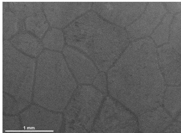
FIGURE III.9 – Microstructure du matériau à l'état de livraison
