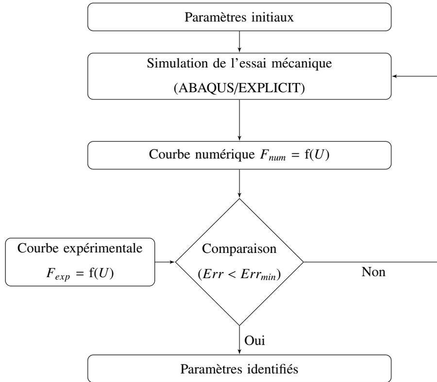
FIGURE III.13 – Identification par la methode inverse
