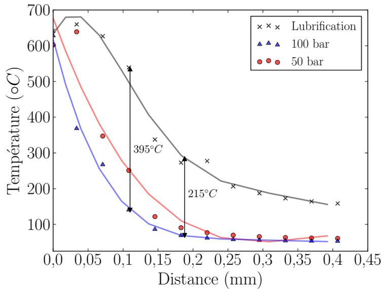
FIGURE III.60 – Evolution de la température sur la face de coupe de l'outil
