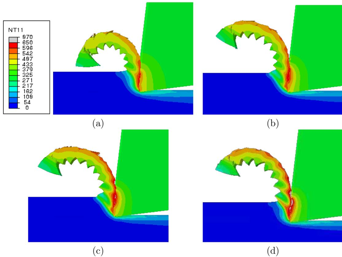
FIGURE III.52 – Champs de température : (a)  $V_c=75$  m/min, (b)  $V_c=100$  m/min, (c)  $V_c=125$  m/min, (d)  $V_c=150$  m/min
