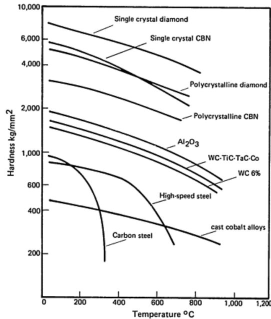
FIGURE I.9 – Evolution de la dureté de différents matériaux d’outil en fonction de la température (Ezugwu *et al.* (2005))
