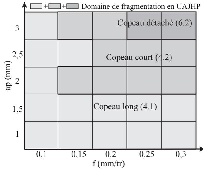
FIGURE II.10 – Domaines de fragmentation du copeau en usinage conventionnel et en usinage assisté
