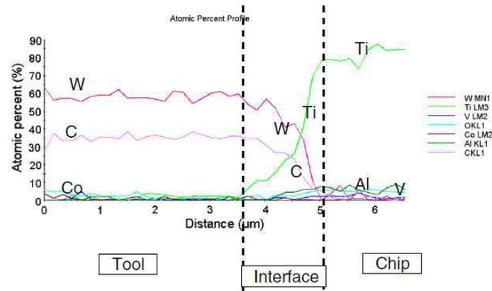
FIGURE II.3 – Exemple de profils de diffusion entre l’outil et le copeau (Nouari et Makich (2013))
