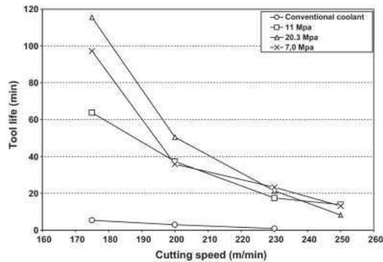
FIGURE I.33 – Variation de la durée de vie de l'outil en fonction de la vitesse de coupe et de la pression du jet (da Silva *et al.* (2013))
