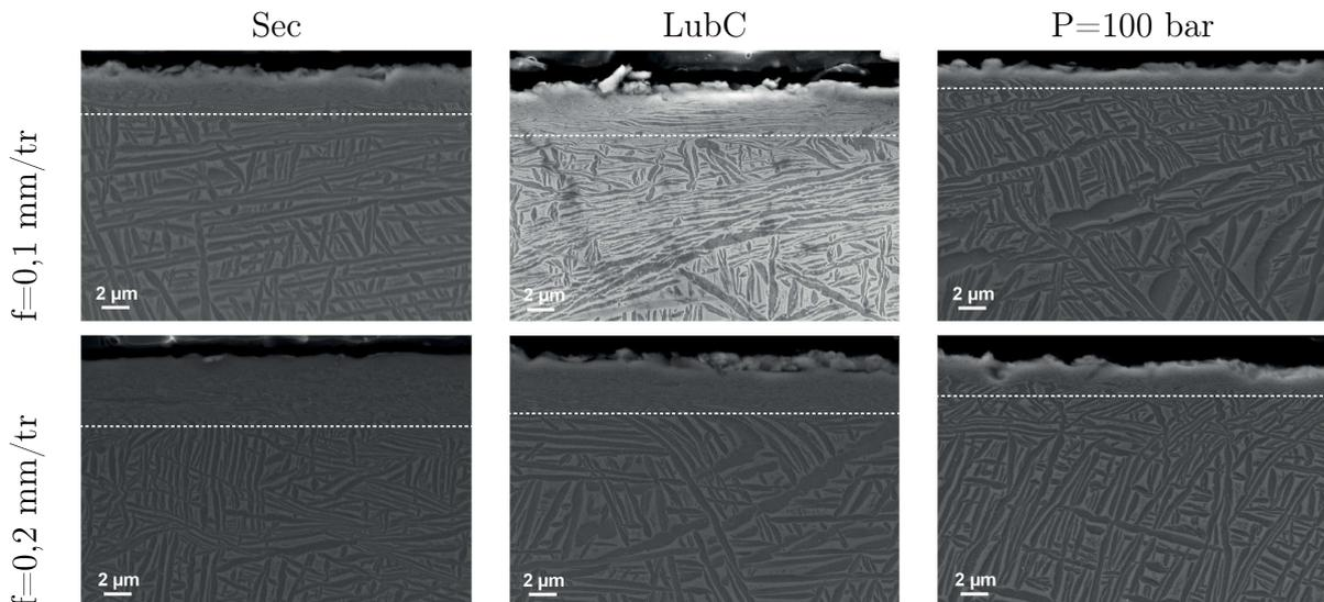
FIGURE III.6 – Observation des zones affectées sur la surface de la pièce pour différentes conditions de coupe et de lubrification
