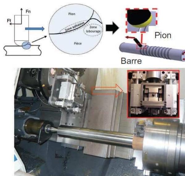
FIGURE III.38 – Tribomètre ouvert Rech *et al.* (2009)
