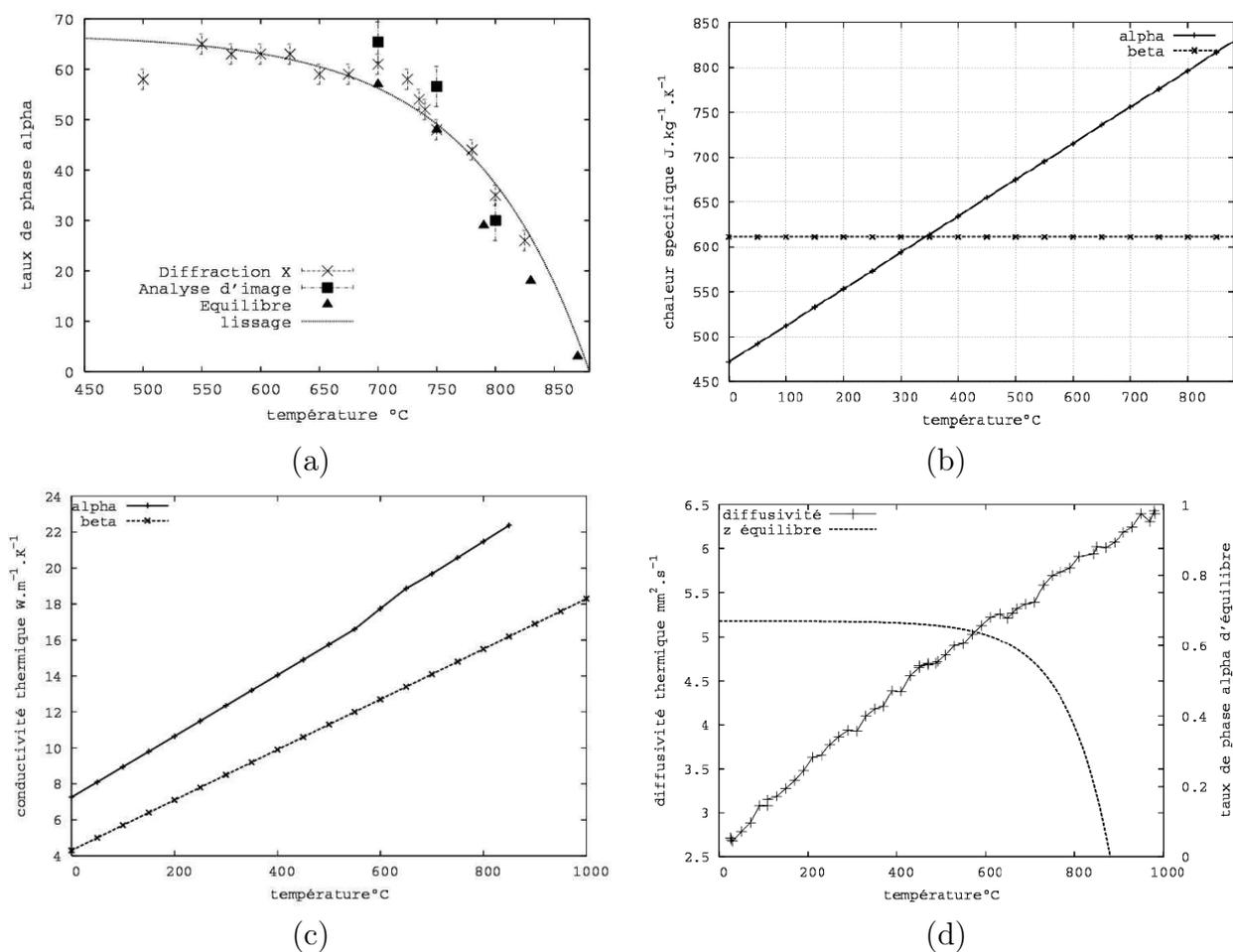
FIGURE B.1 – Evolution : (a) du taux de la phase  $\alpha$  en fonction de la température, (b) de la chaleur spécifique, (c) de la conductivité thermique, (d) de la diffusivité thermique en fonction de la température (Teixeira (2005))
