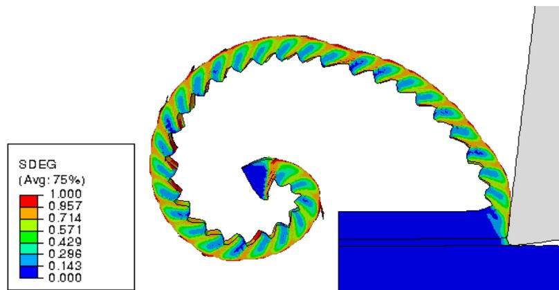
FIGURE III.51 – Morphologie du copeau :  $f=0,1$  mm/tr,  $V_c=125$  m/min
