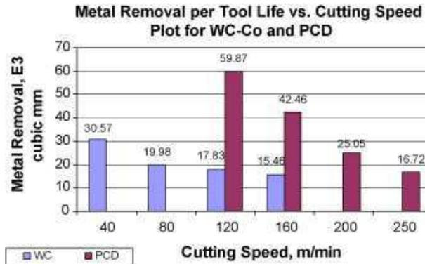
FIGURE I.11 – Taux d'enlèvement de matière avec un outil en PCD et un outil en WC/Co (Amin *et al.* (2007))
