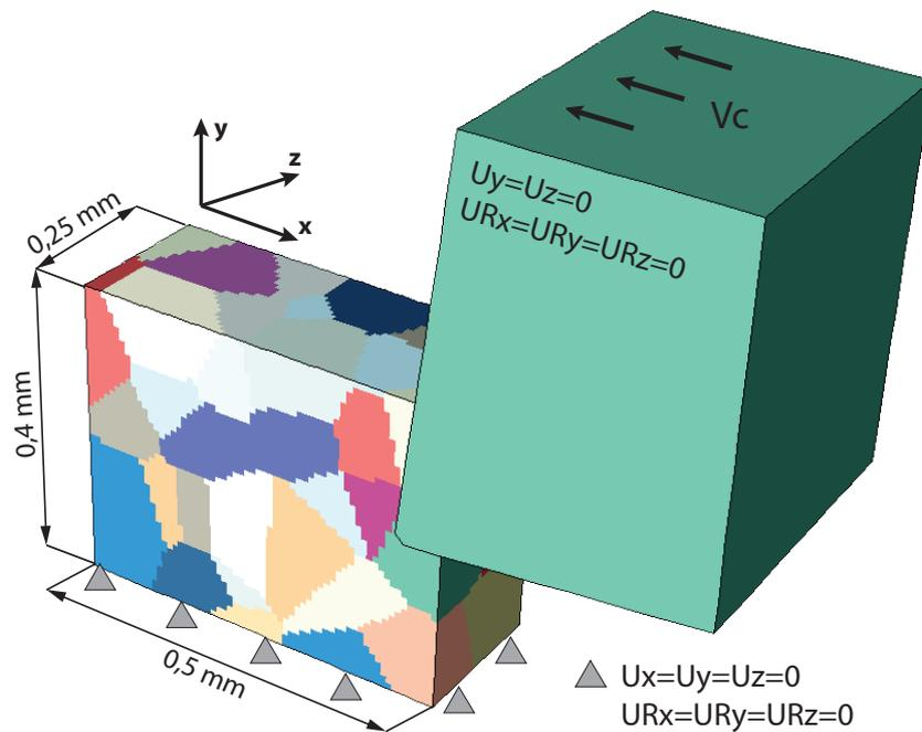
FIGURE III.75 – Modèle géométrique
