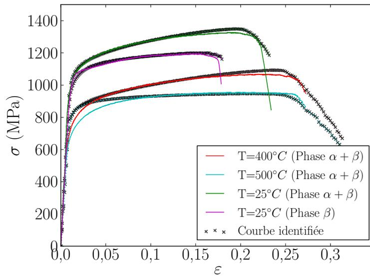
FIGURE III.74 – Identification du comportement du Ti17
