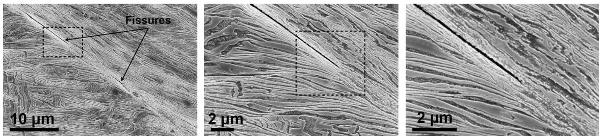
FIGURE III.25 – Bande de cisaillement et fissuration pour un essai de compression ( $T=400^{\circ}C$ ,  $\dot{\epsilon} = 0,1 s^{-1}$ )
