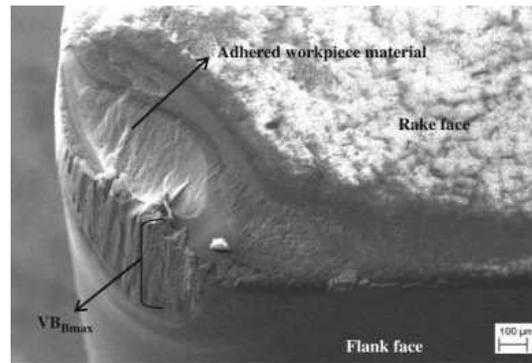
FIGURE I.34 – Adhésion du 316L sur la face de coupe de l'outil ( $P=100$  bar) (Naves *et al.* (2013))
