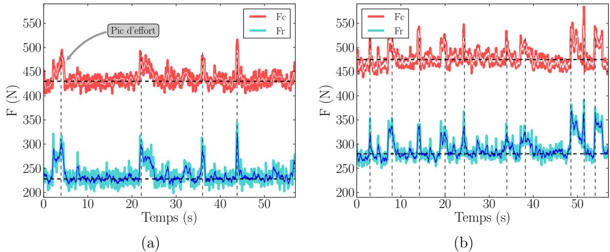
FIGURE II.37 – Evolution de l'effort de coupe et de l'effort radial à la pression de 250 bar, (a) entre 5 min et 6 min, (b) entre 9 min et 10 min
