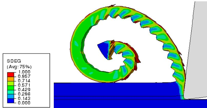
FIGURE III.50 – Morphologie du copeau :  $f=0,1$  mm/tr,  $V_c=75$  m/min
