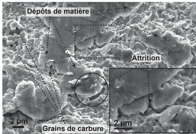
FIGURE II.30 – Dépôts de matière sur la face de coupe après 5 min d'usinage d'ébauche avec une pression de 100 bar
