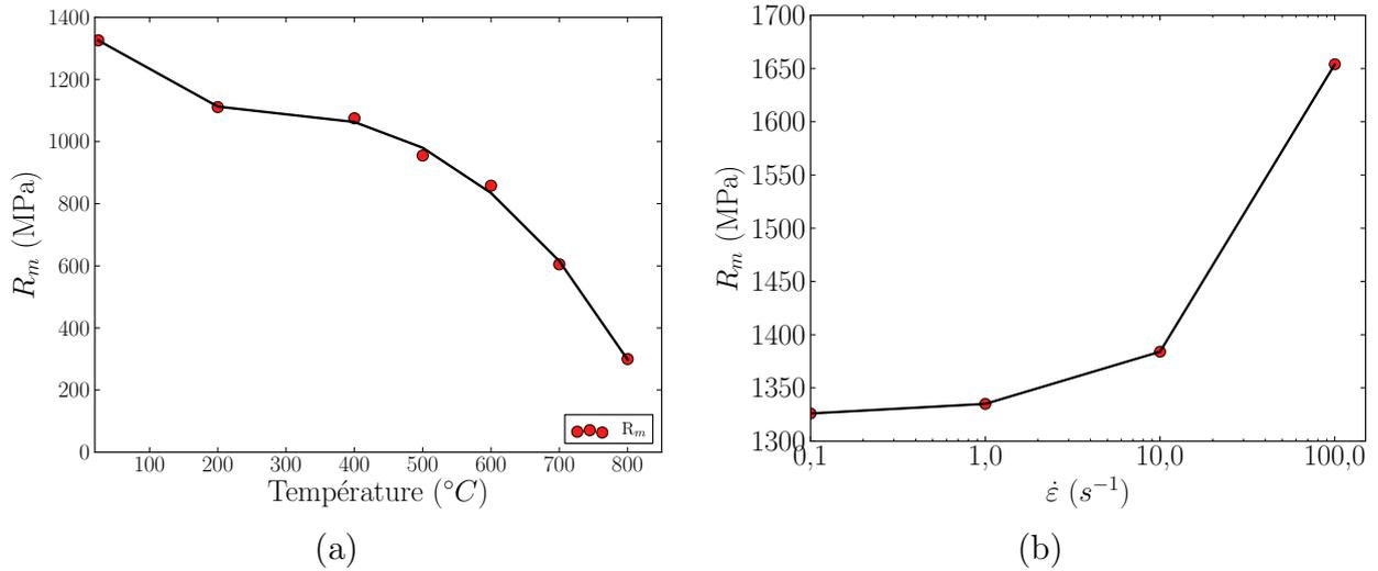
FIGURE III.15 – (a) évolution de  $R_m$  en fonction de la température, (b) évolution de  $R_m$  en fonction de la vitesse de déformation
