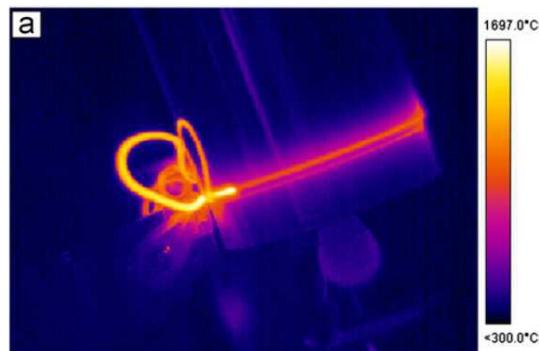
FIGURE I.22 – Niveaux de la température dans la pièce et dans le copeau en usinage assisté laser (Rashid *et al.* (2012a))
