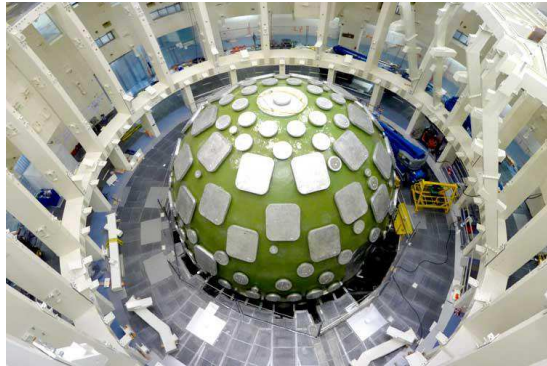
Cible du LaserMégaJoule (énergie, défense, recherche)
