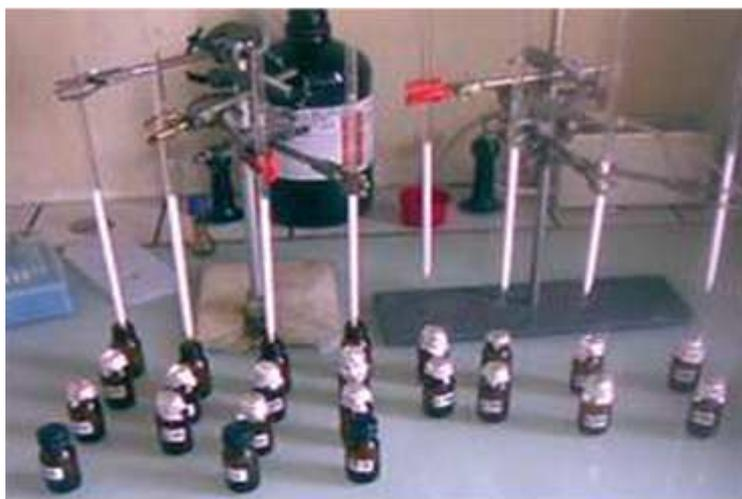
Figure 35: Colonnes de silice et flacons de récupération des fractions éluées
