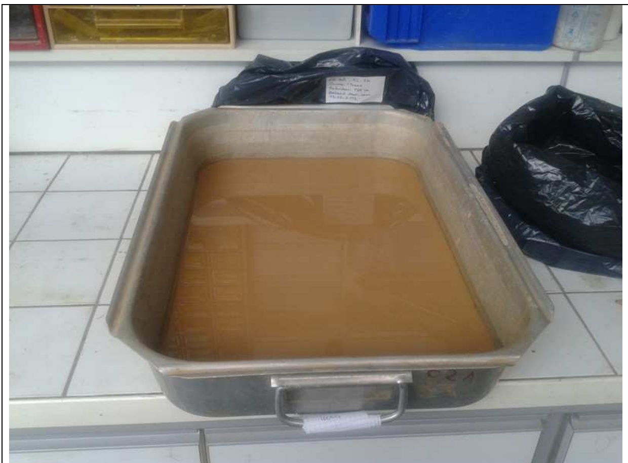
Photo 4. Les particules passantes le tamis 0,08 mm laissé sur la paillasse pour décanter
