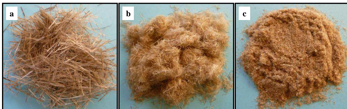
Figure II.10. Fibres de lin de différentes tailles (a) Fibres Lintex 10 mm, (b) Fibres Nattex coupées à 2 mm, (c) Fibres Nattex coupées à 0,5 mm (la photographie a ici modifié la couleur des fibres de lin qui ont en réalité une couleur typique de la filasse rouie)
