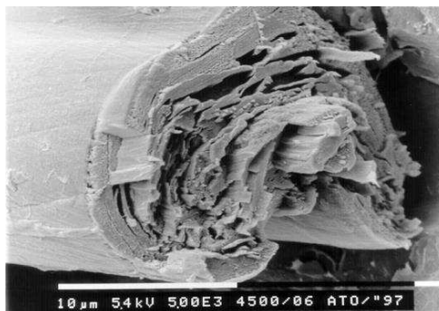
Figure I.14. Micrographie MEB d'un faciès de rupture d'une fibre de lin - Mise en évidence de la structure en couches concentriques de la paroi secondaire [Bos et al. (2002)]
