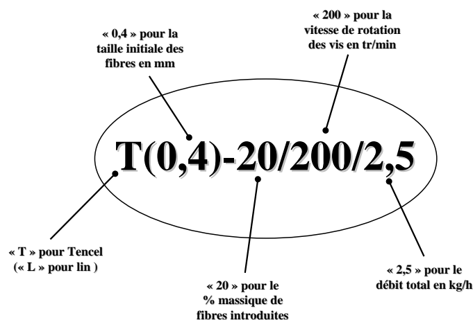
Figure V.5. Nomenclature utilisée pour désigner les mélanges. Cas d'un mélange réalisé avec 20 % en masse de fibres Tencel ® 0,4 mm, à une vitesse de rotation de 200 tr/min et avec un débit total de 2,5 kg/h
