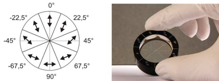
FIGURE 3.6 – Convertisseur de polarisation linéaire en polarisation radiale ou azimutale. A gauche : Orientation des axes neutres des segments de lames demi-ondes. A droite : Photographie d'un convertisseur 8 segments.
