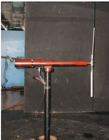
Figure 5.3 Modèle expérimental du rotor - essais en soufflerie
