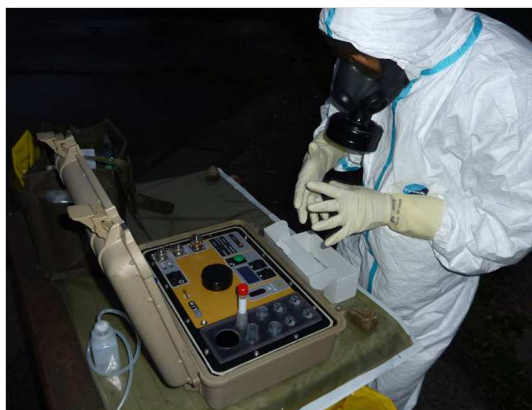
FIGURE 2.1 – Mallette commercialisée par Bertin utilisant la technique MOA.
