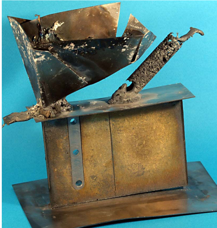
Figure 35: plaque de 5 mm démoulée. Dans la partie supérieure se trouvent le cône de coulée et l'évent. Le chenal de coulée est reconnaissable grâce à l'insert en acier doux. Cette pièce est percée de 3 trous afin de la maintenir en place à l'aide de pions dans le moule fermé. Une tôle en acier est placée en dessous et au-dessus de l'espace à remplir de métal liquide afin que ce dernier ne se trouve pas en contact direct avec les pièces en céramique.
