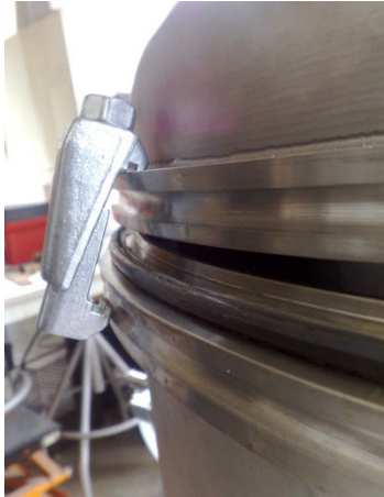
Figure 16: à gauche, le bridage du couvercle, en noir le joint d'étanchéité. À droite, l'arrivée de l'alimentation électrique à l'arrière du four
