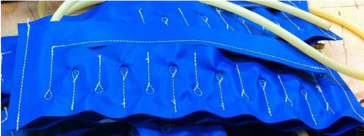
Fig. III-1 : Muscle pneumatique Otherlab.
