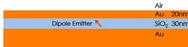
FIGURE 2.6 – Schéma de la structure 1D. Sur un substrat d'or, un dipôle est placé au milieu d'une couche de silice surmontée d'une couche d'or de 20nm d'épaisseur.
