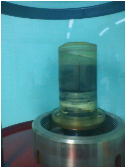
Figure 3.11. Echantillon dans le lyophilisateur, à gauche (étape 6) et découpe du piston inférieur à droite (étape 7)
