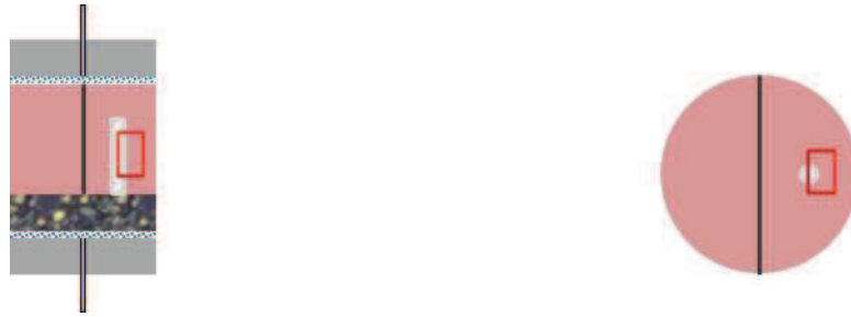
Figure 4.30. Localisation de l'interface observée, coupe longitudinale et transversale, avec et sans bactéries, interface fer massif/argilite
