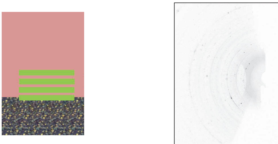
Figure 3.17. Réalisation de pointés parallèles à l'interface réalisé en montage rasant, à gauche et exemple de cliché de diffraction obtenu sur l'image plate en montage rasant, à droite
