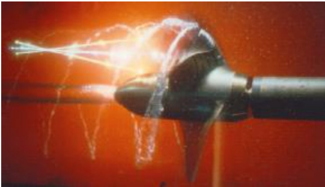
Figure 2 – 1 : Essai d'une hélice en tunnel de cavitation « MIT's Variable Pressure Tunnel Dr. Kinna » - 1996
