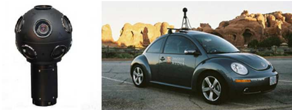
Figure 2-23 : Système mobile terrestre avec imagerie seule
