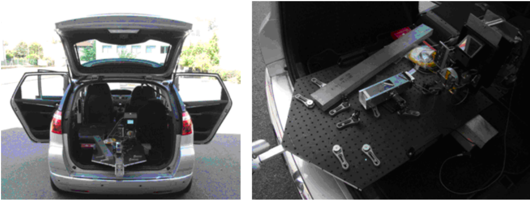
Figure 6-14 : Scanner mono-plan sur véhicule
