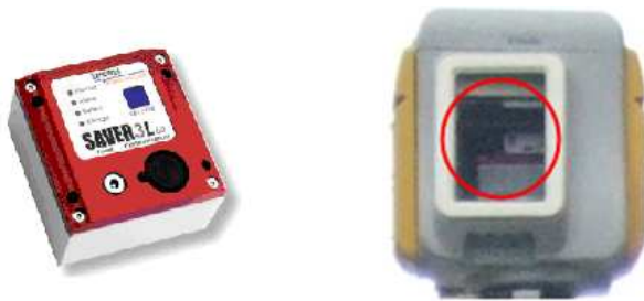
Figure 4-4 : Trimble GX avec accéléromètre
