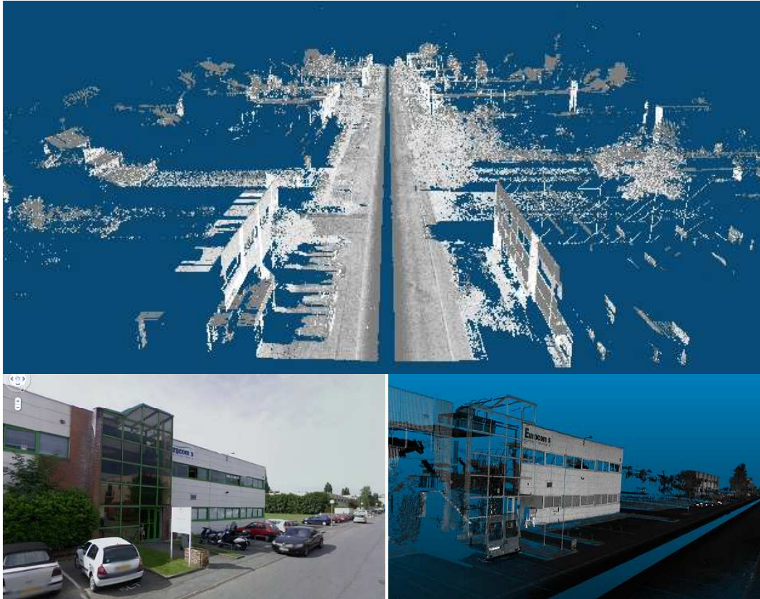
Figure 6-17 : Nuage de points obtenu avec le concept 1 (mono-plan vertical)
