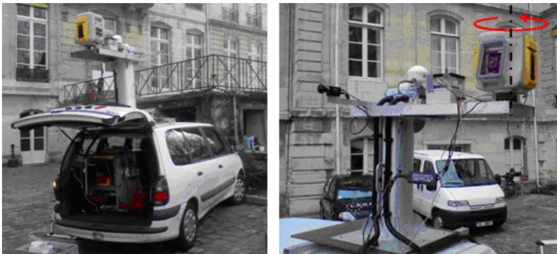
Figure 4-8 : Trimble GX sur LARA-3D
