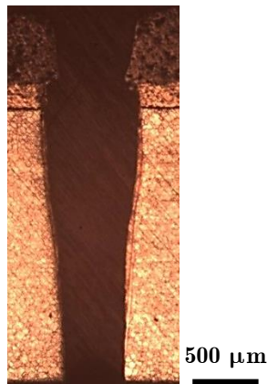
Figure 2.33. Micrographie d'un perçage sur KCN22W revetu ( P_{crête} = 13 \text{ kW} , \beta = 90^\circ , 4 impulsions).
