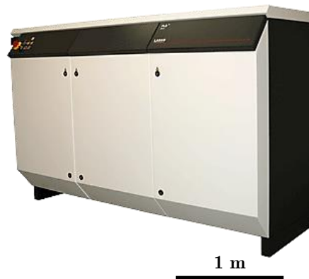
Figure 1.2. 2013 : Source laser pulsée Nd:YAG FLS A de chez LASAG (Rofin) pouvant délivrer plusieurs dizaines de kilowatts de puissance crête pendant 20 ms à 500 Hz.
