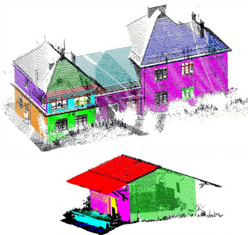
Figure 9.25 Détection de plans – Riegl2012_Slomniki . Paramètres fixés : \sigma=0.01\text{m} , P=0.99 , N_{pt}=16 , R=0.200\text{m} , k=25 , N_{min}=200 . Une couleur correspond à un plan (points non segmentés en noir)
