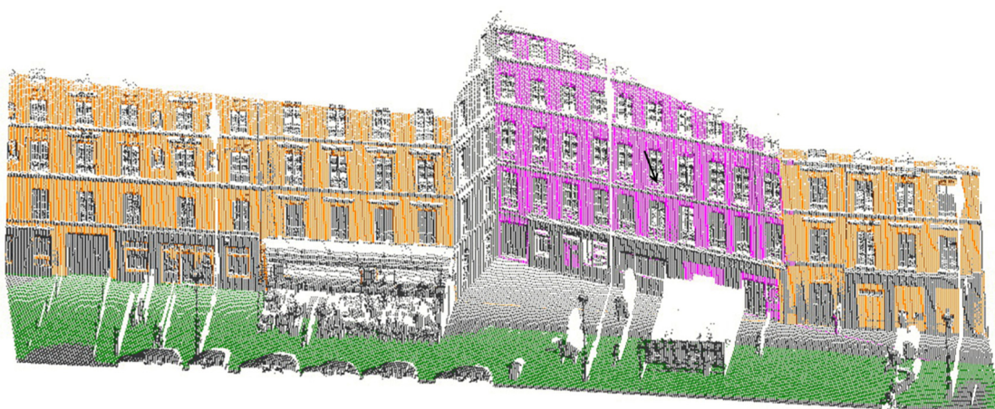
Figure 9.8 Détection de trois plans successifs par RANSAC . Une couleur correspond à un plan
