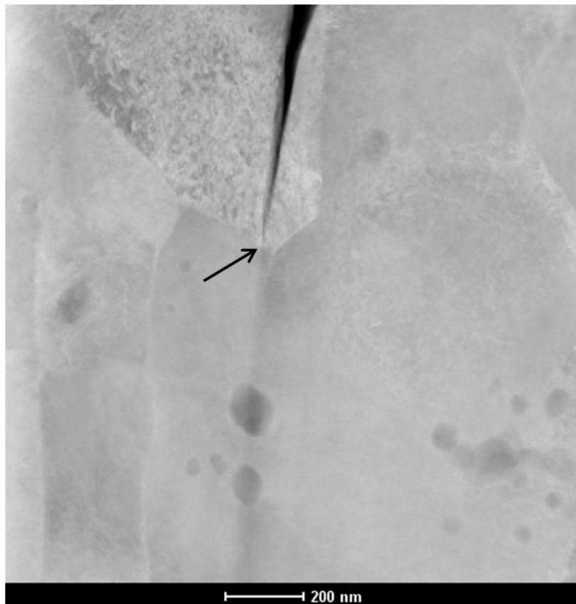
Figure IV-66 : Fissure secondaire de clivage arrêtée sur un joint de grain sur la nuance J27.
