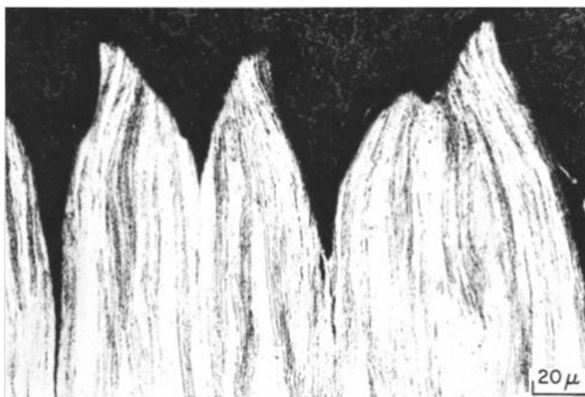
Figure IV-4 : Zones de striction localisées entre les fissures de délaminage [Bramfitt-1977].
