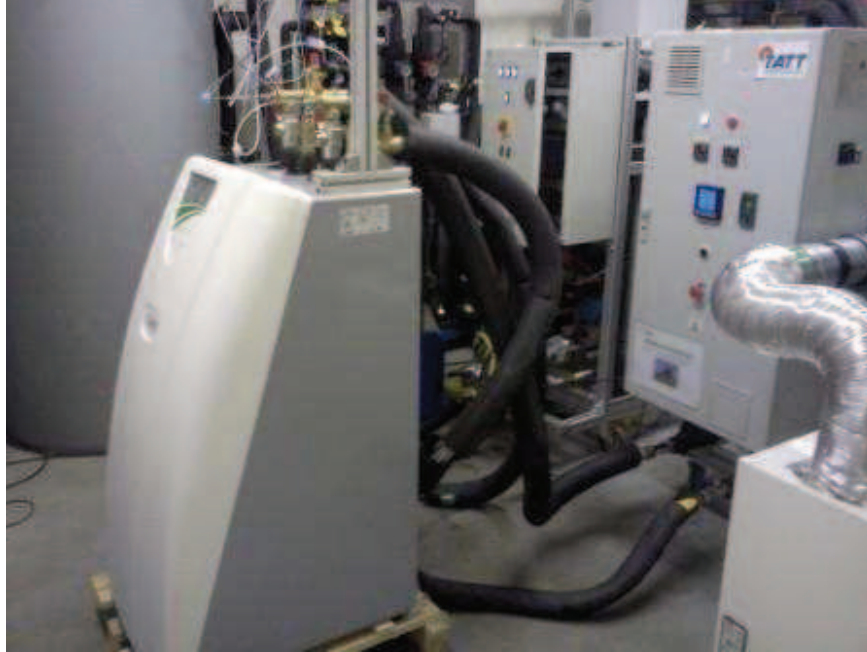
Figure 127. Banc d'essai de la PAC eau/eau de marque CIAT réalisé par l'INES (Bourget du Lac)
