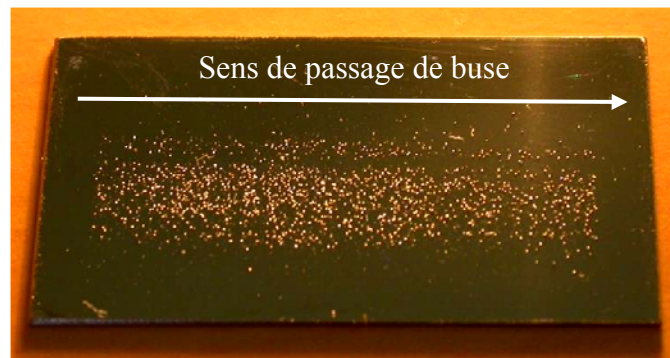
Figure 5.18: Cliché macroscopique de splats de titane déposés sur substrat TA6V de 50 \times 25 \text{mm}^2 .
