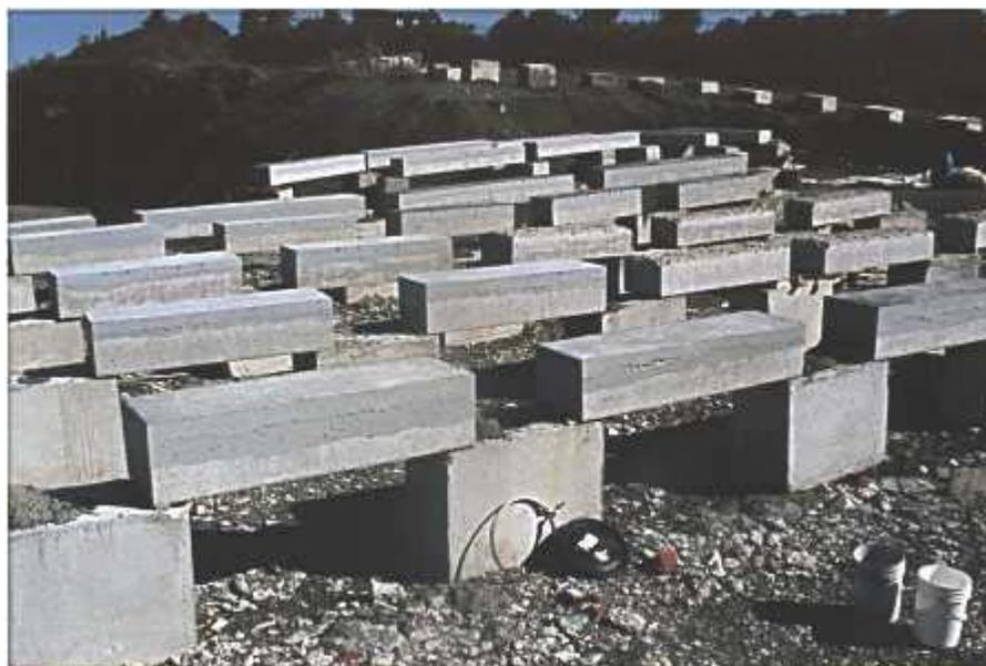
Figure 4.2: Support en béton armé de section 400x600 mm et de longueur 2 m sur le site d'exposition à Québec
