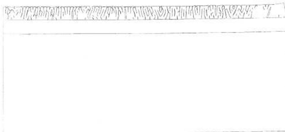
Figure 11.35: Schéma de fissuration de la réparation de 50 mm en mortier ordinaire après 380 jours de séchage
