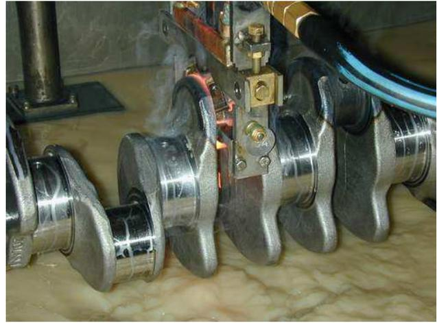
*Figure I.16 : Chauffage du maneton 3, inducteur en position PMH*
