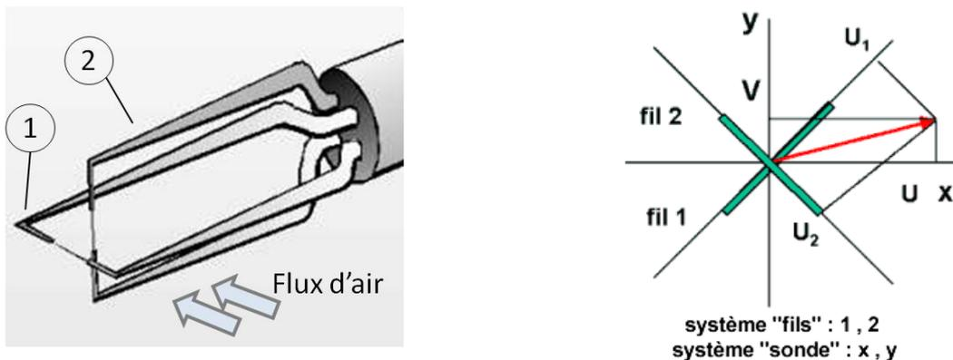
Figure 2.6 - Anémomètre à deux fils croisés pour la mesure de deux composantes de la vitesse
