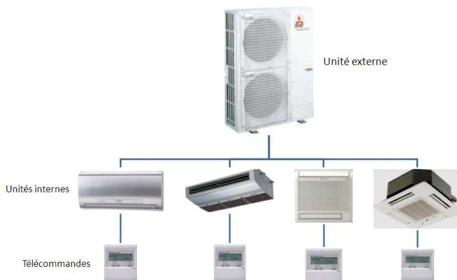
Figure 1.18 - Configuration d'une PAC air/air multi split
