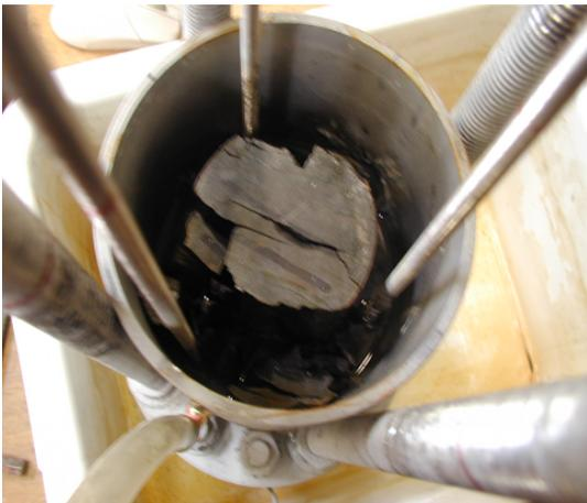
FIG. 5.21 – Rupture de l'éprouvette pour une contrainte axiale de 1 MPa
