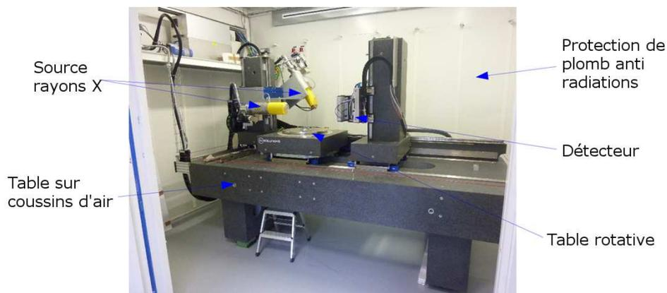
FIGURE 2.12 – Vue du tomographe de laboratoire Navier (UMR CNRS 8205)
