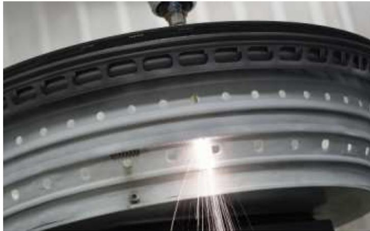
FIGURE 1.15 – Exemple d'un perçage sur une chambre de combustion. Source CRMA
