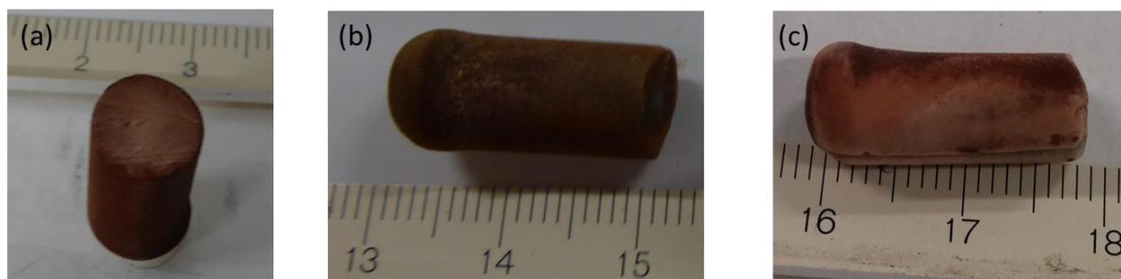
**Figure 59 : Monolithes fonctionnalisés en statique sous agitation mécanique (agitateur rotatif) (a), dans un réacteur à micro-onde (b) et suivi d'un lavage sous flux (c).**
