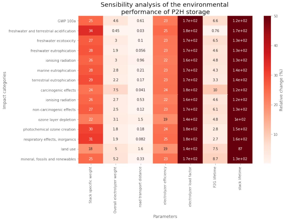
FIGURE 4.3 – Matrice d'analyse de sensibilité multicritère du stockage P2H
