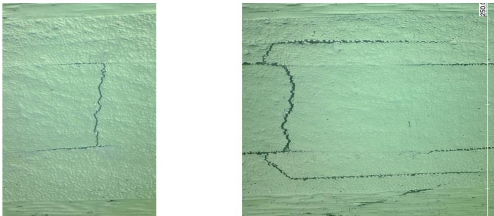
**Figure 4.26** – Observation des fissures interlaminaires en bord d'éprouvette.
