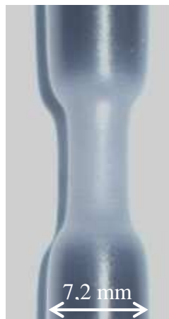
Figure III-1 : Zone strictionnée d'une éprouvette lisse sollicitée en traction
