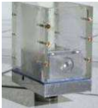
Figure II-4 : Cuve étanche utilisée pour les essais sous conditions humides
