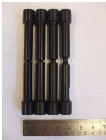
Figure II-2 : Photographie des éprouvettes entaillées de l'étude et définition des paramètres géométriques de l'entaille
