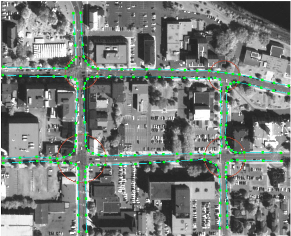
FIG. 5.21: résultat final après l'extraction des intersections
