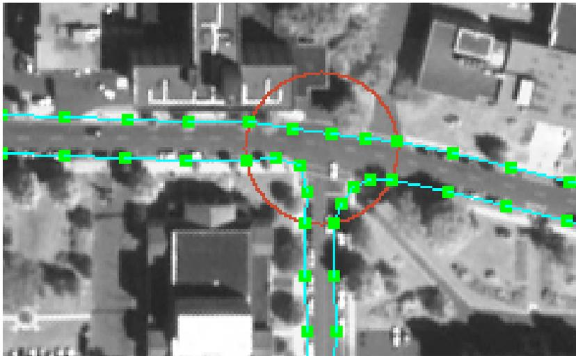
FIG. 5.22: résultat final d'extraction : zoom sur l'intersection entre les rues 5, 7 et 8
