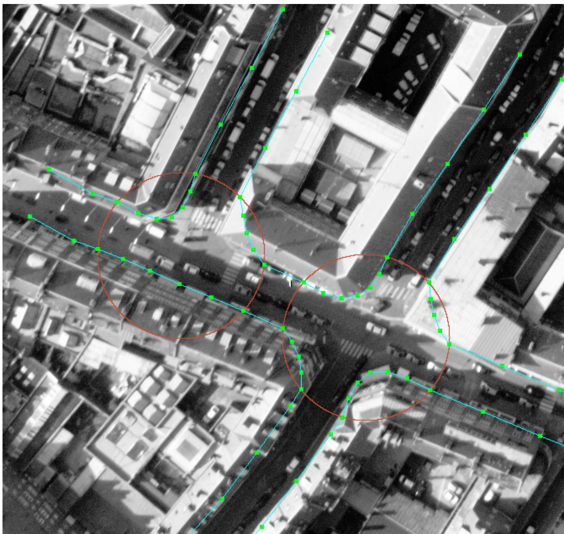
FIG. 5.29: résultat final après l'extraction des intersections
