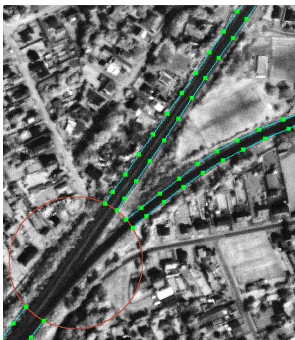
FIG. 5.11: après traitement des contours parallèles
