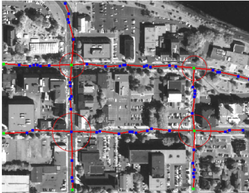
FIG. 5.18: obtention du graphe topologique
