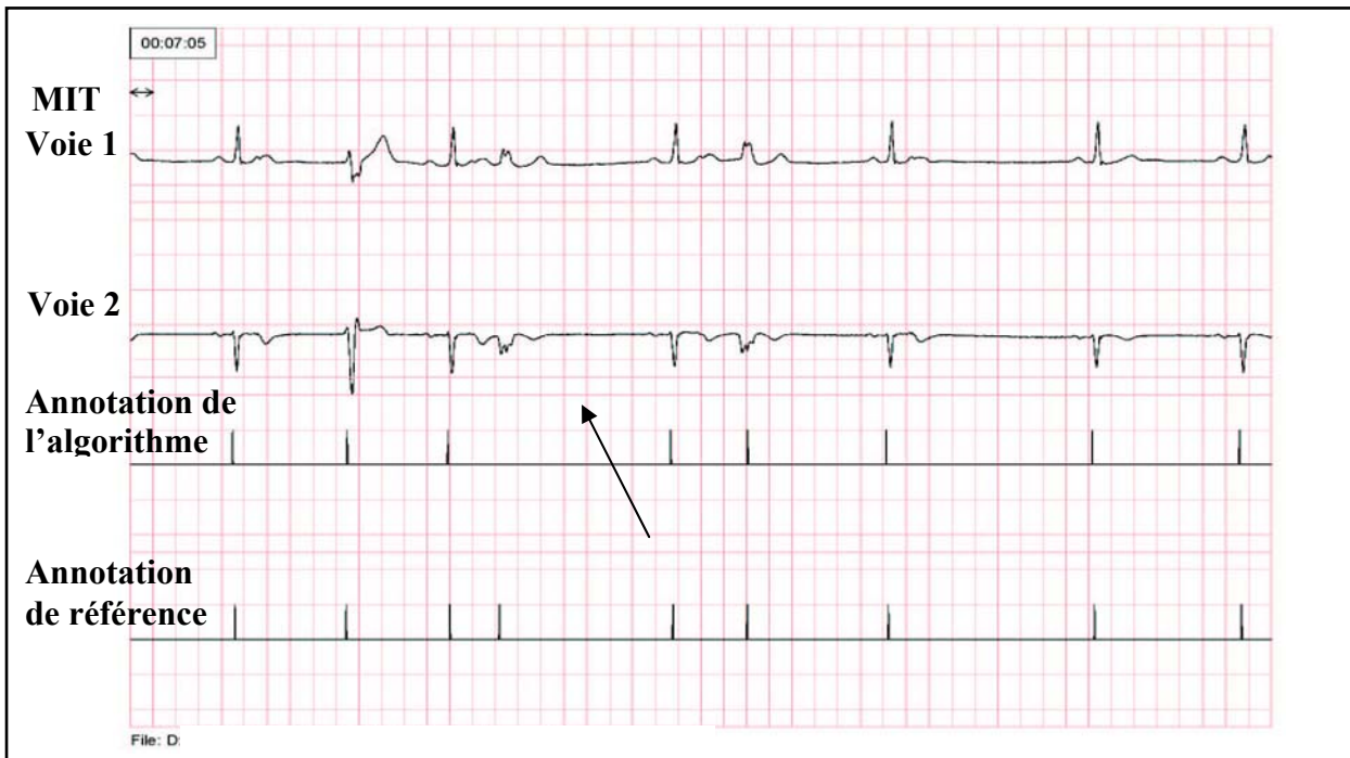
Figure 4 : L'extrasystole n'a pas été détectée. Sa forme est en effet trop étalée, et sa projection trop petite pour qu'elle soit repérée par l'algorithme. C'est un faux négatif (FN).
