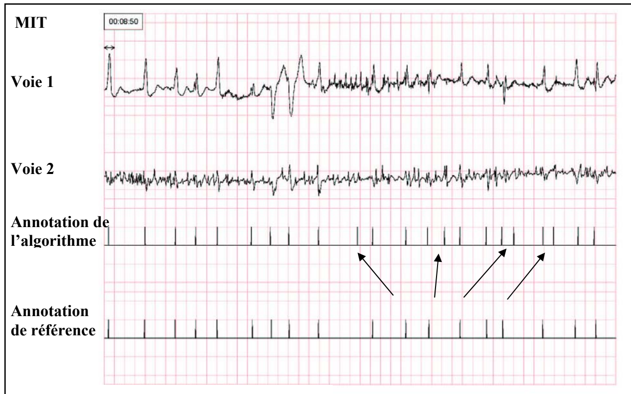
Figure 3 : L'enregistrement est ici très bruité en moyenne fréquence : les pics de bruit ressemblent beaucoup aux QRS voisins. L'algorithme n'a donc pas sélectionné cette zone comme zone trop bruitée, et a introduit des faux positifs (FP).
