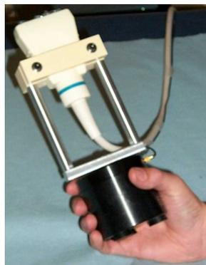
Figure V-6: Montage expérimental pour l'Elastographie Impulsionnelle. La sonde ultrasonore est liée à un pot vibrant donnant le coup basse fréquence. Le médecin tient l'ensemble par le pot.
