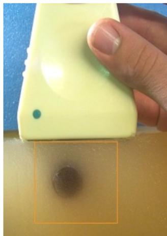
**Figure VII-1: Photo du gel hétérogène. L'inclusion est visible grâce à quelques gouttes d'encre ajoutées dans le mélange lors de la fabrication.**
