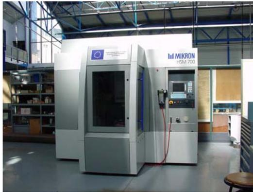
Figure 2.11 – Centre d'usinage à grande vitesse.
