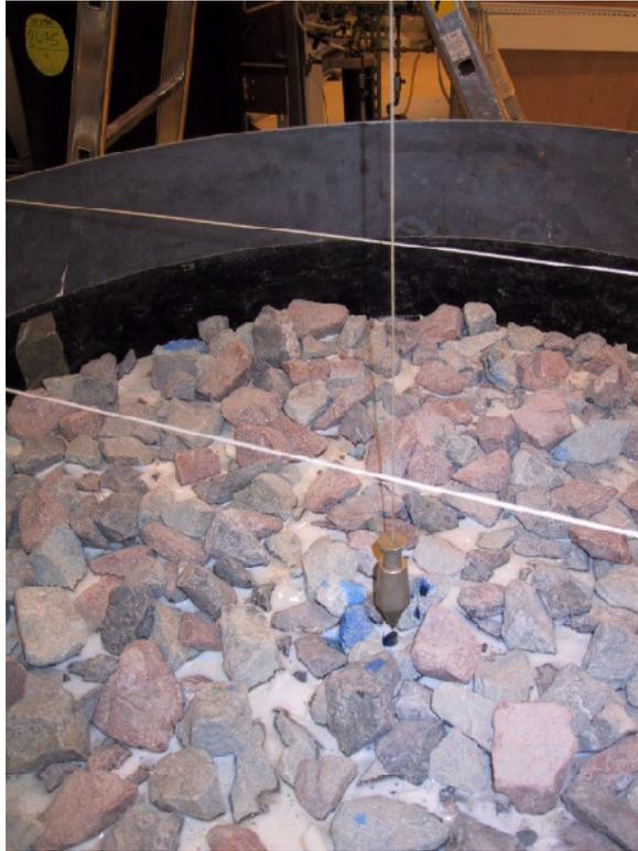
Figure IV-13 : Détail de la mise en place des repères centraux et de direction transversale pour marquage de la plaque moulant la géomembrane
