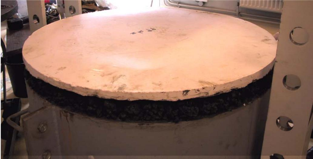
*Figure AV-1: le moulage est placé sur la couche d'argile*
