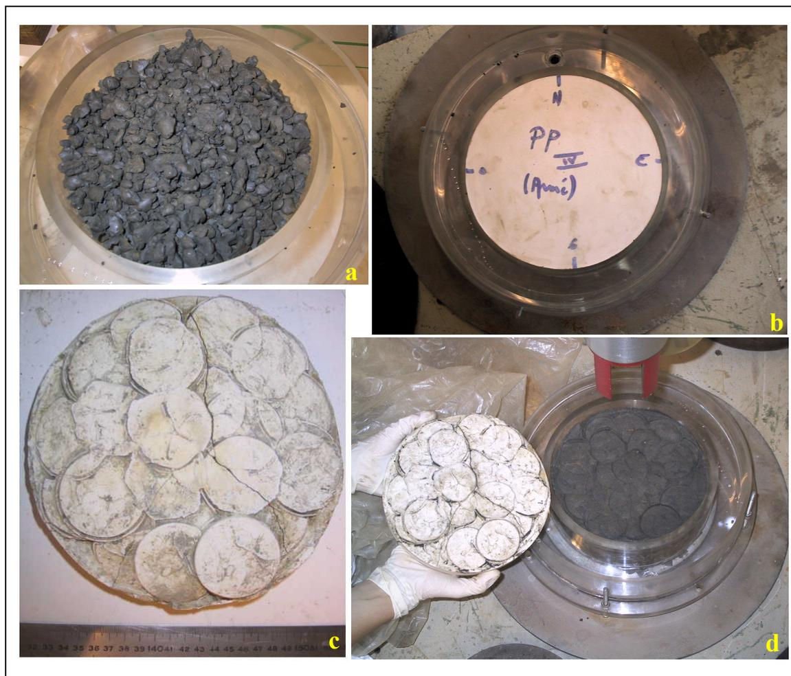
Figure IV-8 : Protocole de reproduction d'état de surface artificiel
