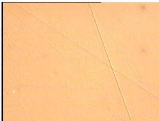
**Figure 2.25** Vue microscopique d'une surface de YCOB polie au diamant.
