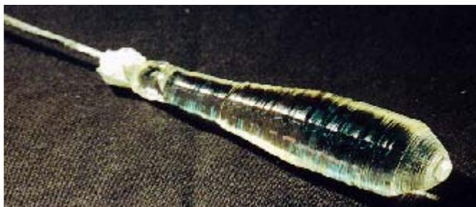
**Figure 3. 2.** Canon monocristallin de  $Sr_3Y(BO_3)_3:Yb^{3+}$  13.7 at. % élaboré par la méthode de croissance Czochralski sur tige d'iridium.
