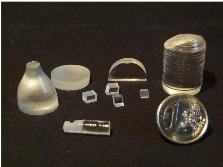
Figure 3. 15. Différents stades dans la préparation de cristaux laser de  $(Sr_{1-x}Ca_x)_3 Y_{1-y}Yb_y (BO_3)_3$ , ( $x=0.3, y=0.15$ ), à partir d'un monocristal élaboré par la méthode de Czochralski.
