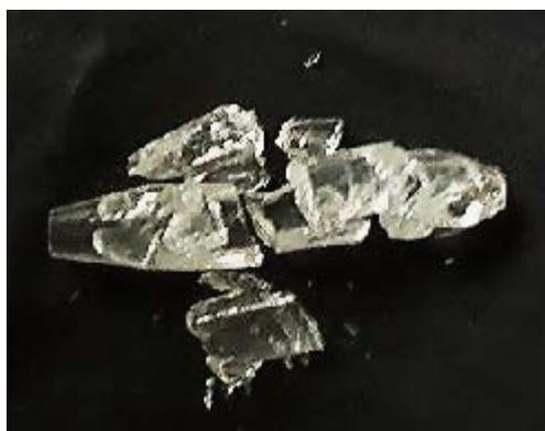
**Figure 3. 3** Canon de  $Sr_3Y(BO_3)_3$  fracturé.
