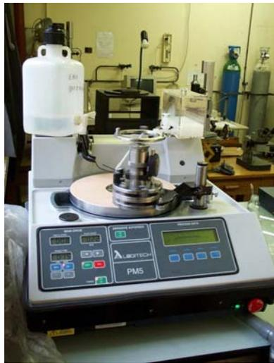
**Figure 2.7** Polisseuse PM-5 (Struers-Logitech).
