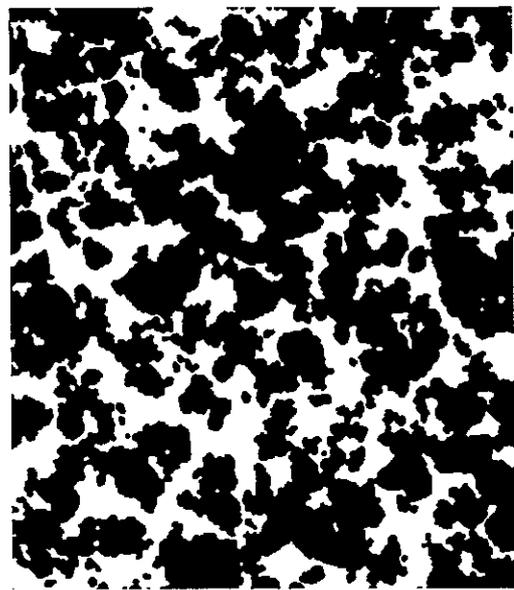
FIG. 1.9 - *Microstructure d'un biphasé 50% Nickel 50% Argent :  $680\mu\text{m} \times 770\mu\text{m}$*
