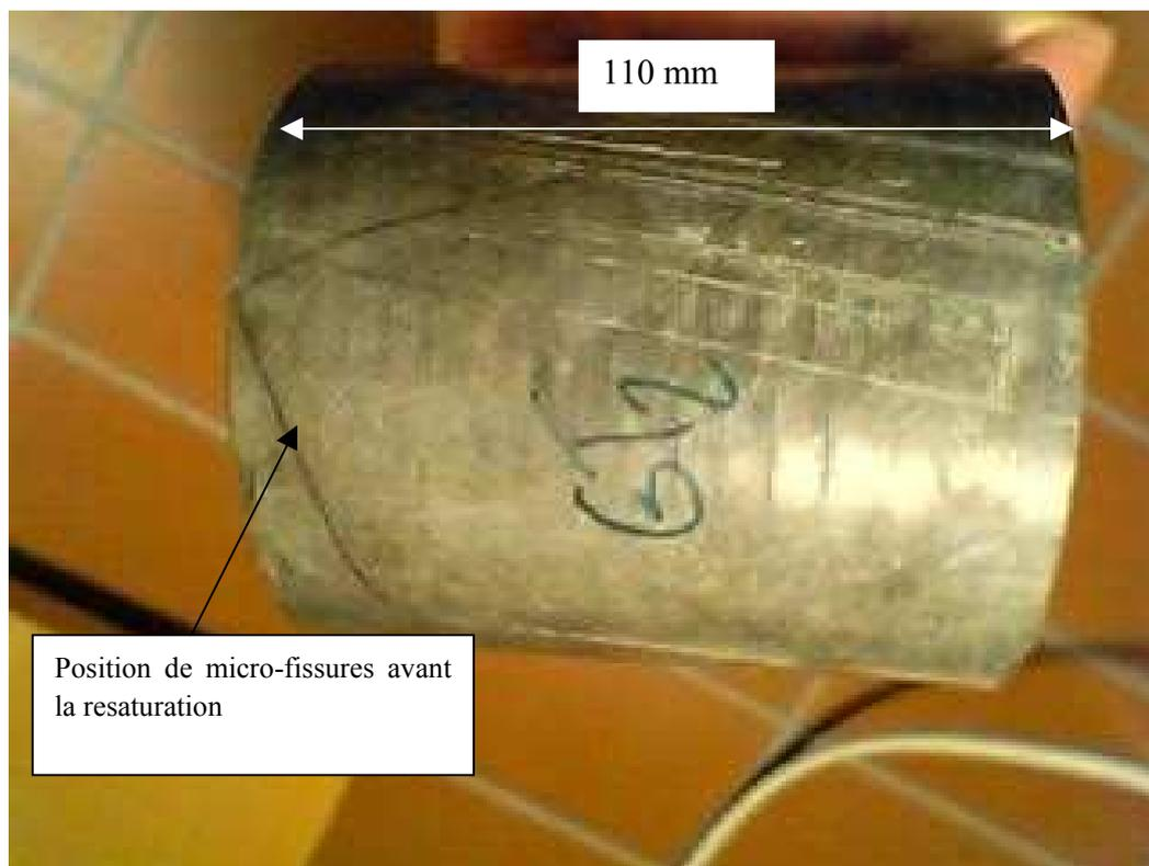
Figure 4-25a : Micro-fissures à la surface extérieure du tube épais GT2 avant la resaturation.
