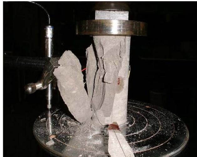
c) rupture pour l'essai (44% RH).
