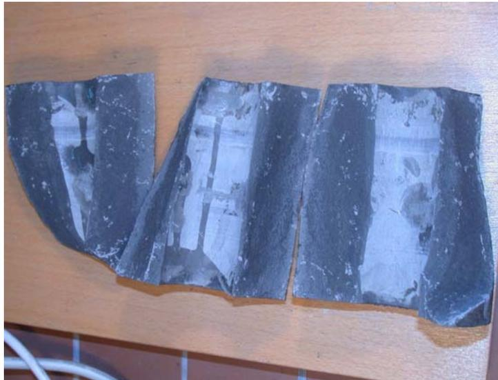
Figure 4-25d : Rupture du tube épais GT2.
