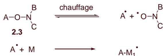
Figure 2- 16 : Amorçage de la NMP
