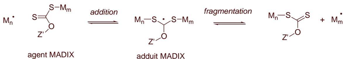
Figure 4- 1 : Principe du procédé de polymérisation MADIX
