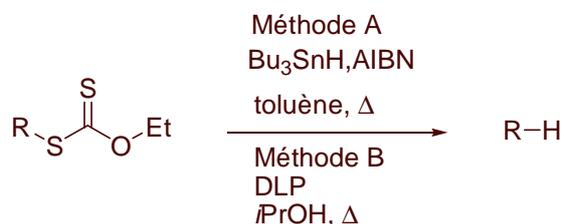
Figure 1- 32 : Réduction de la fonction xanthate
