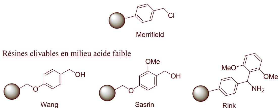
Figure 3- 6 : Quelques attaches parmi les plus connues
