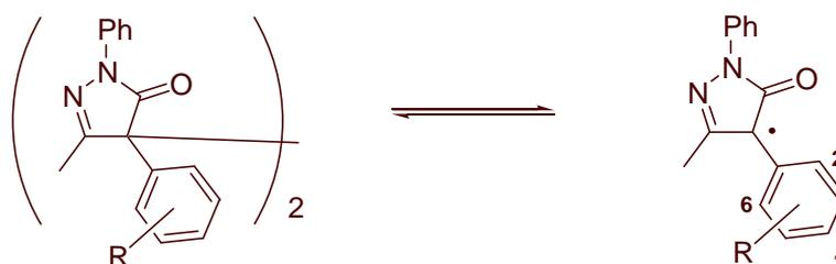
Figure 4-7 : Dissociation des dimères bi-pyrazolones réalisée par Hüttel
