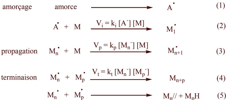
Figure 2-1 : Principe de la polymérisation radicalaire classique
