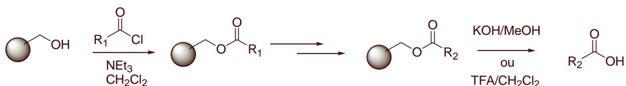
Figure 3- 12 : Mode d'utilisation de ces supports
