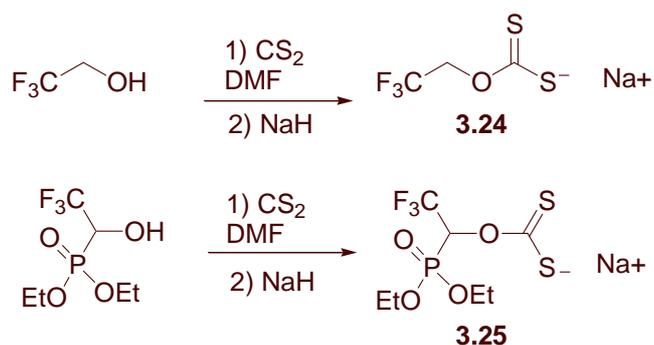
Figure 3- 24 : Préparation des sels de xanthogénate **3.24** et **3.25**
