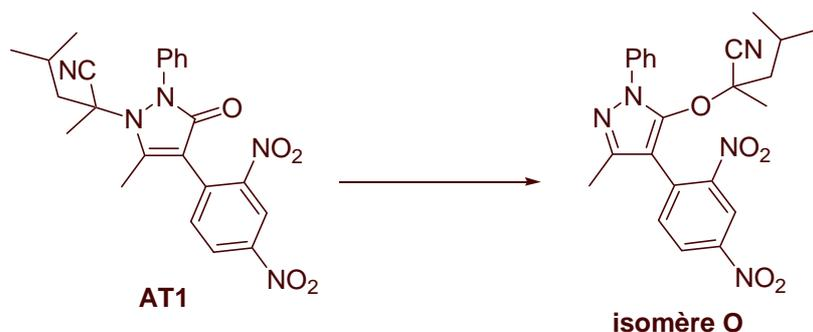
Figure 5- 9 : Isomérisation de AT1 en cours de polymérisation
