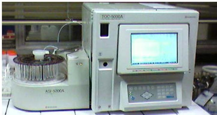
Figure 230 : Appareil pour le dosage du carbone organique total (COT)
