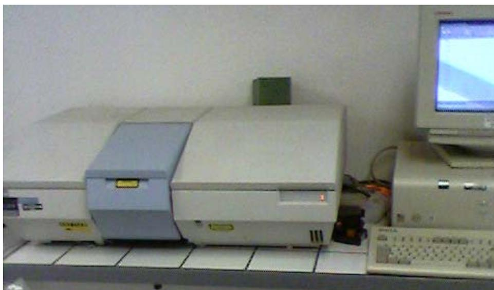
Figure 237 : Spectromètre FTIR Perkin Elmer
