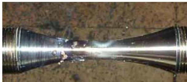
Fig. 121. Eprouvette avec copeaux collés après un usinage avec assistance laser
