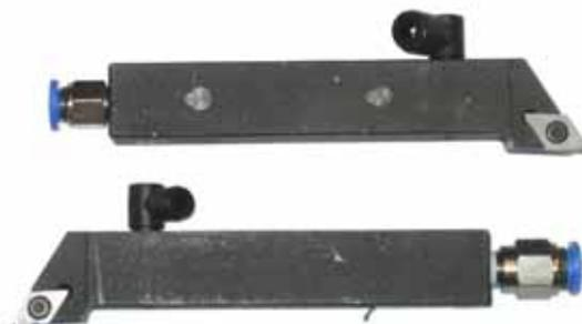
Fig. 42. Outils de coupe avec refroidissement intégré
