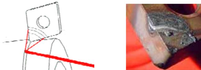
Fig. 89. Dégradation de l'outil due à la réflexion laser
